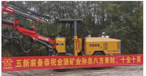
金源矿业本溪铁矿 断面: 4.0m×4.0m / 4.5m×4.5m
